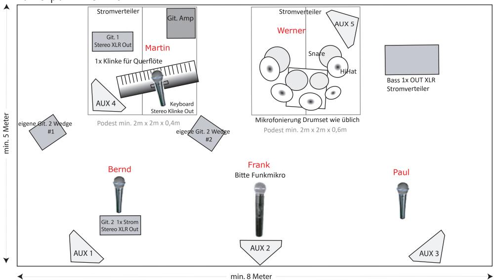
Notfalls können AUX 1 und AUX 3 auch gekoppelt werden. Micros und Ständer bitte stellen. AUX 5 (Drum-Monitor) sollte möglichst mit 15-zöller oder inEar sein.
